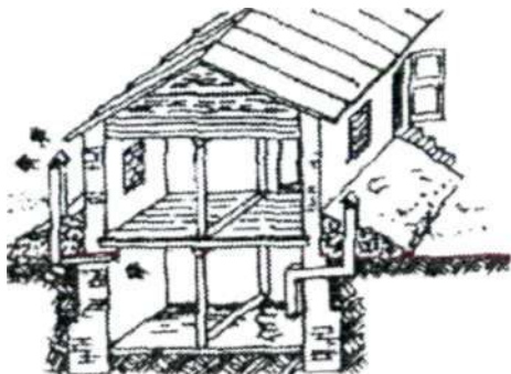
Рис. 3. ПРУ в подвале.
